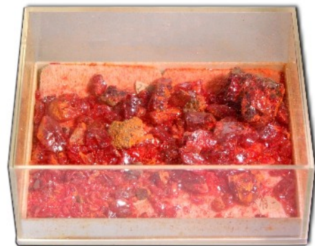
Abb. 2: Realgar Kristalle können an der Luft zu giftigem Arsenolith zerfallen. Sie sollten deshalb stets in gut versiegelten Plastikdöschen aufbewahrt werden.
